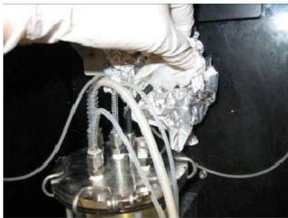
打开发酵罐的过滤器
